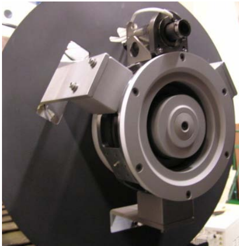
HiVHAC 3.5 kW EM Thruster
